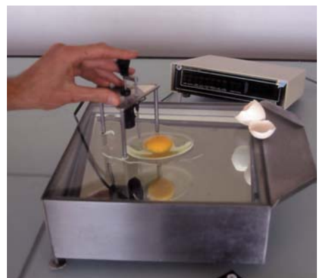
Bild unten: Elektronische Messapparatur, wie sie zur stichprobenweisen Erhebung der Haugh-Einheiten bei den Eiersammelstellen zum Einsatz kommt.
